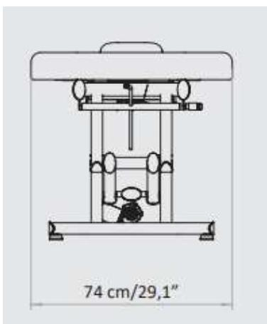
Bei der Lemi Sosul E1 ist die Liegenhöhe bequem mittels Fußschalter elektrisch verstellbar. Die Einstellung des Rückenteils erfolgt manuell mit Unterstützung einer Gasdruckfeder, Fuß- und Beinteil sowie Kopfteil werden manuell eingestellt. Das vielseitige Massagekopfteil ist im Lieferumfang inbegriffen. Der Unterbau ist in elliptischer Form, aus Stahl gefertigt und pulverbeschichtet. Die Polsterung besteht aus einem Qualitäts-Schaumstoff, welcher mit Kunstleder bezogen ist.
